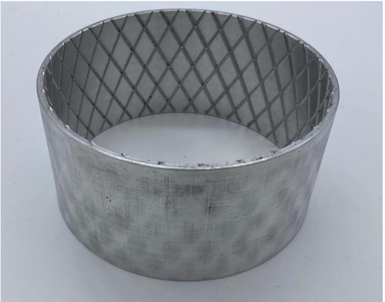
Рисунок 3.17 – Деталь с сеткой рифлей, полученная при рифлении рабочей оправкой типа III
