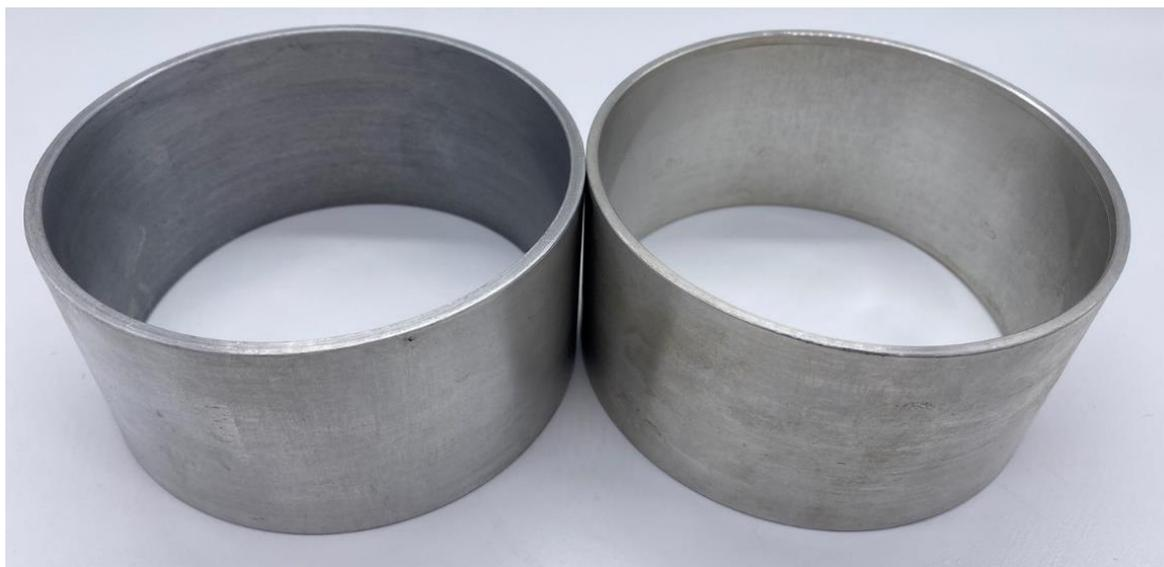
Рисунок 3.14 – Алюминиевые заготовки для нанесения рифлей
