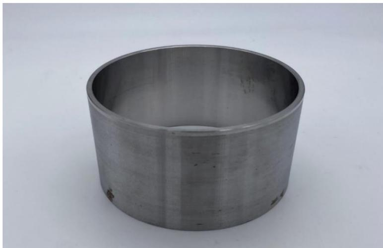
Рисунок 3.20 – Стальная заготовка для нанесения рифлей
