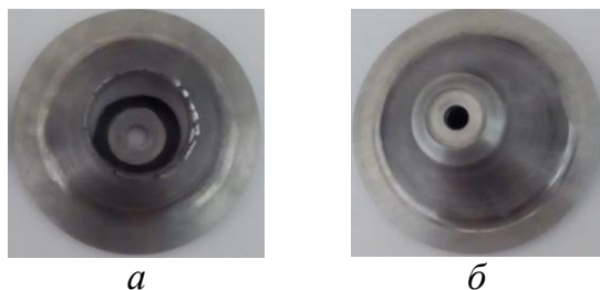
Рисунок 3 – Полуфабрикаты, полученные в результате ротационной вытяжки:
