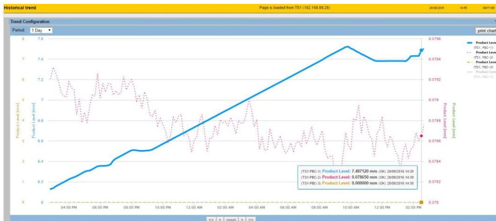
Рисунок 1.10 – Исторический тренд Tankvision (изменение параметров за отрезок времени)
