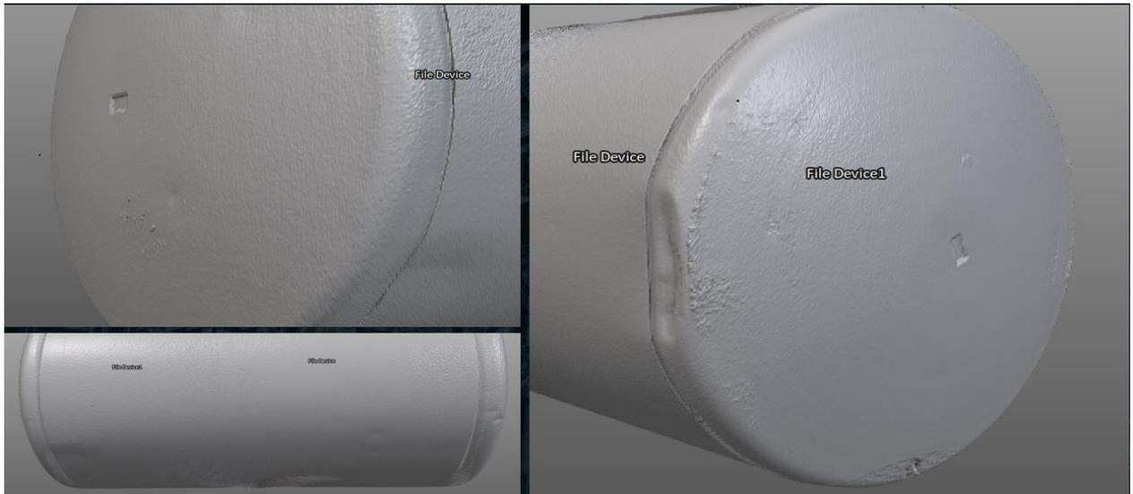
Рисунок 2.12 – Смоделированные деформации резервуаров
