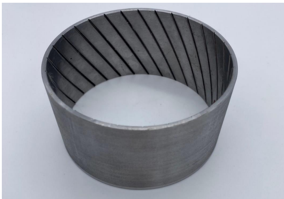
Рисунок 3.21 – Стальной полуфабрикат, полученный при первом рифлении рабочей оправкой типа III
