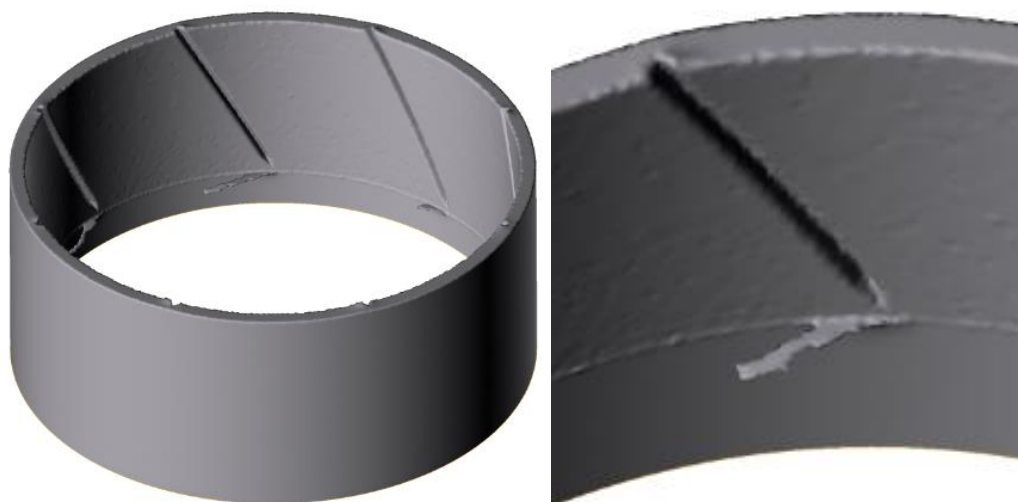
Рисунок 2.10 – Фронтальный наплыв материала при рифлении рабочей оправкой типа III при зазоре Z = 0 мм
