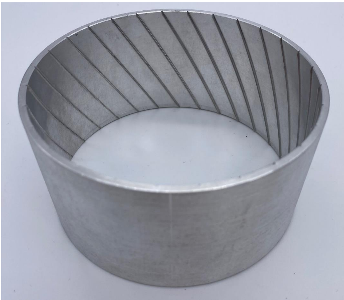
Рисунок 3.16 – Полуфабрикат, полученный при первом рифлении рабочей оправкой типа III
