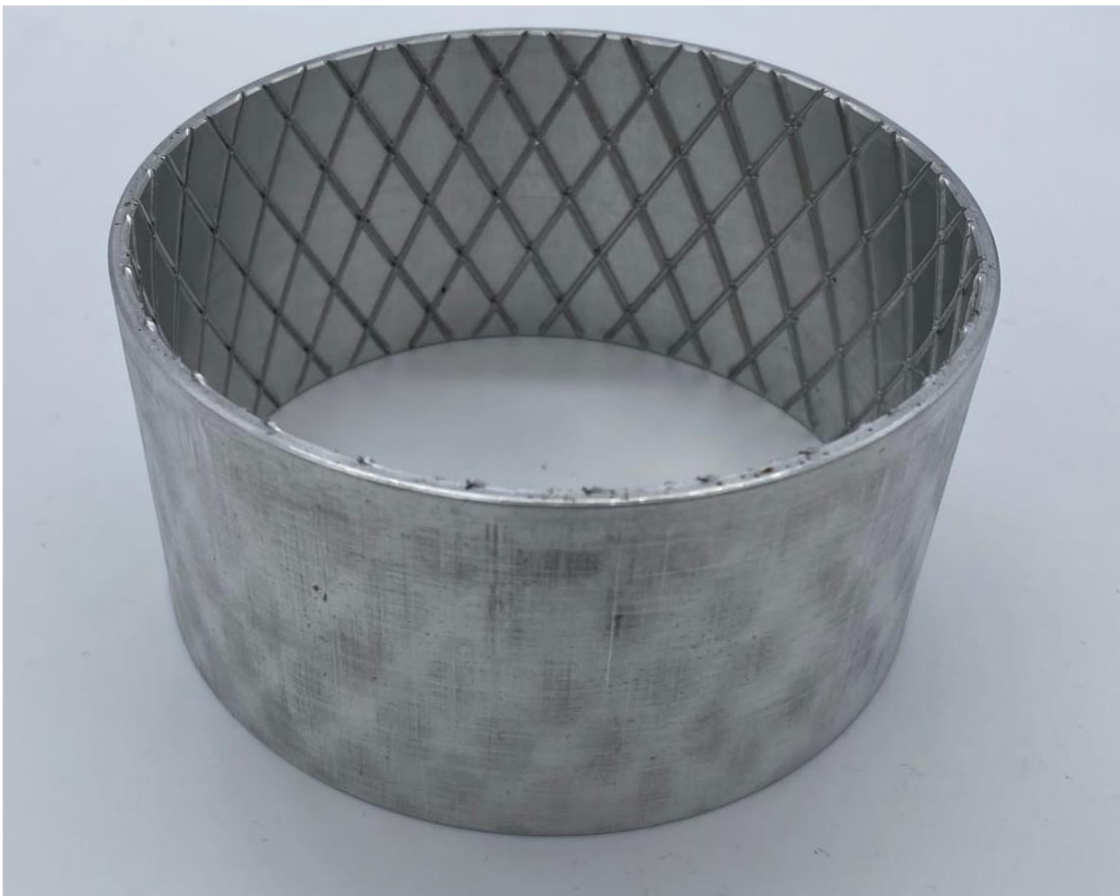
Рисунок 3.17 – Деталь с сеткой рифлей, полученная при рифлении рабочей оправкой типа III
