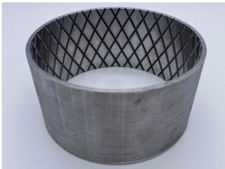
Рисунок 3.22 – Стальная деталь с сеткой рифлей, полученная при рифлении рабочей оправкой типа III
