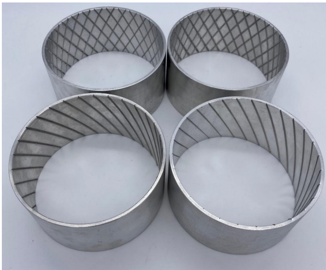
Рисунок 3.19 – Полуфабрикаты с рифлями одного направления и детали с сеткой рифлей
