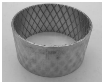
Рисунок 7 – Образец с сеткой рифлей, полученной при рифлении рабочей оправкой типа III
