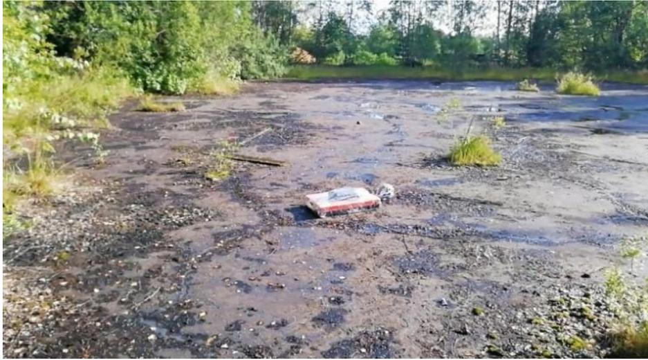
Рисунок 2.14 – Перемещение георадара по поверхности смоляного озера
