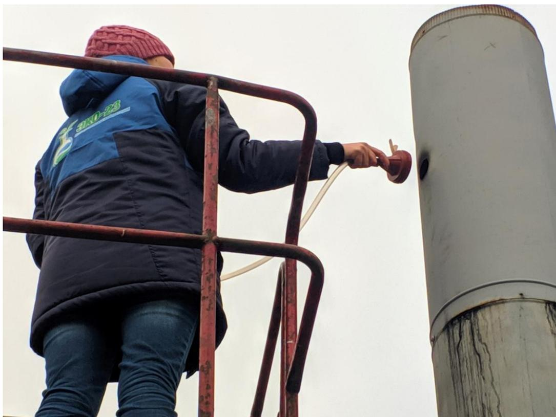
Рисунок 3.10 – Замер исходящих выбросов вредных веществ во время сжигания, точка Т.1
