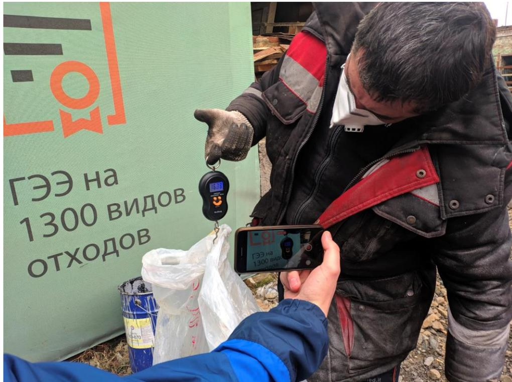
Рисунок 3.7 – Контрольное взвешивание объединённой пробы перед загрузкой в камеру сгорания
