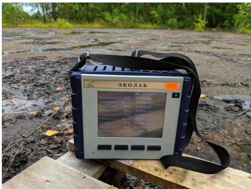
Рисунок 2.11 – Исследование состава атмосферного воздуха газоанализатором «ЭКОЛАБ» на большом смоляном озере
