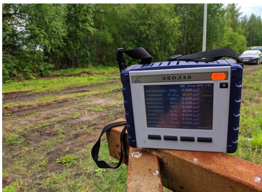
Рисунок 2.12 – Определение компонентных показателей на участке
