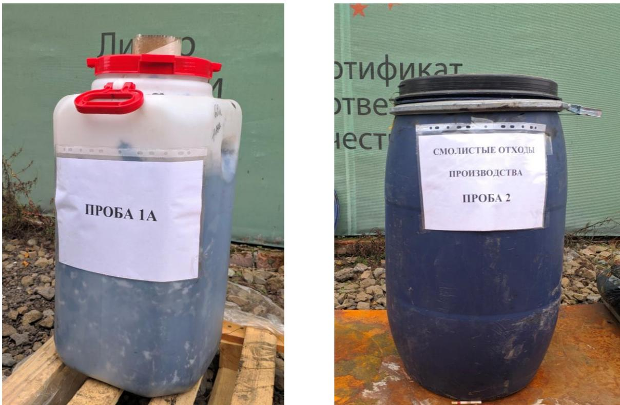
Рисунок 3.6 – Пробы смоляных отходов на промышленной площадке сжигания
