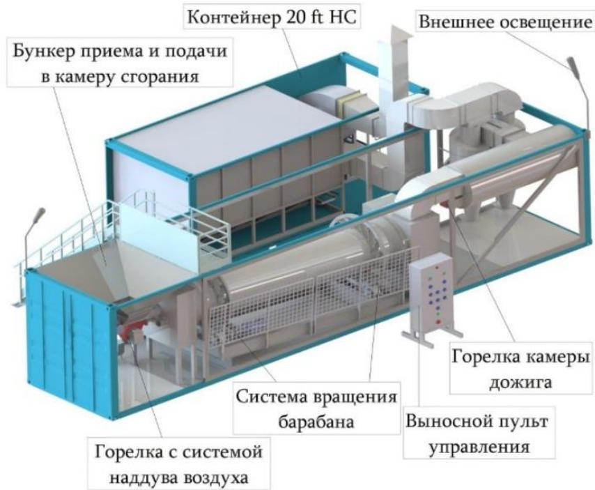
Рисунок 3.2 – Общий вид 1-й установки ТДУ «Фактор-2000»
