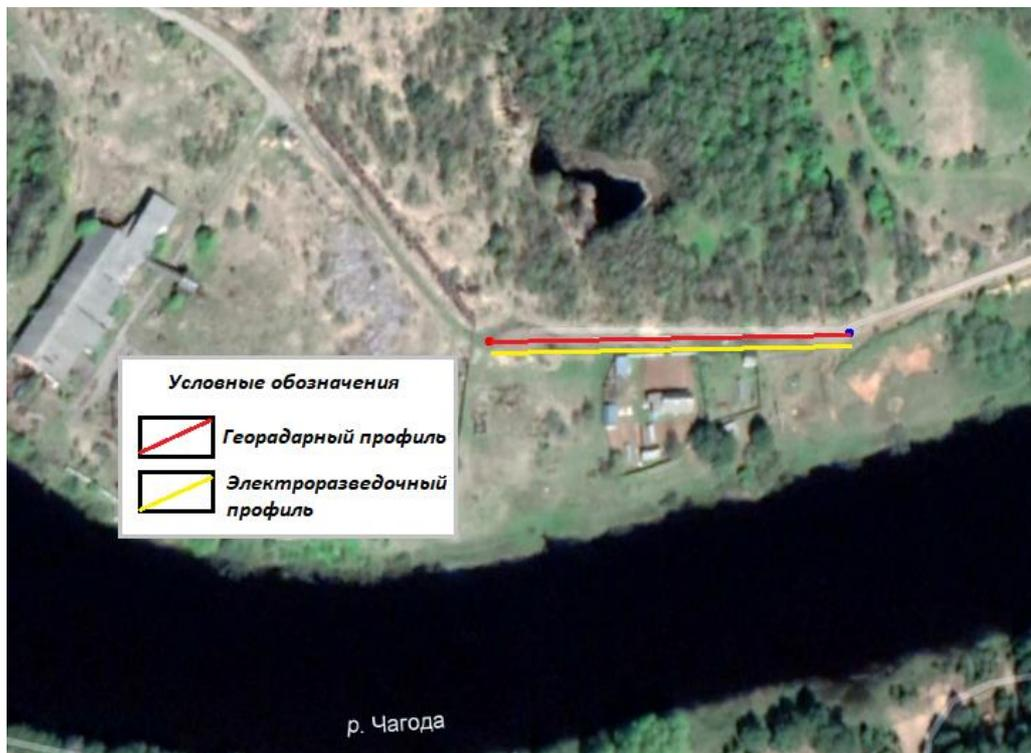
Рисунок 4.4 – Профили геофизического опробывания рассматриваемого земляного вала
