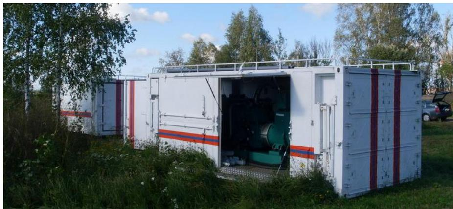
Рисунок 3.12 – Мобильная установка плазменной газификации и уничтожения отходов «ПЛАЗАРИУМ MGS»
