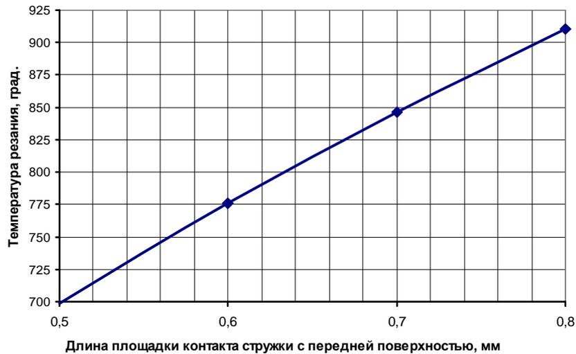
Рис. 5. Влияние длины контакта стружки с плоской передней поверхностью на температуру резания (по А.Н. Резникову)
