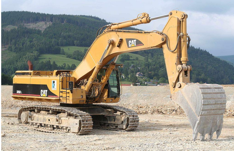
Рисунок 1.5 - Одноковшовый экскаватор, оснащённый гидравлическим приводом с объёмным управлением
