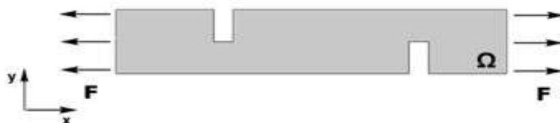
Рисунок 2.12 – Форма пластины без армирования и расчетная схема
