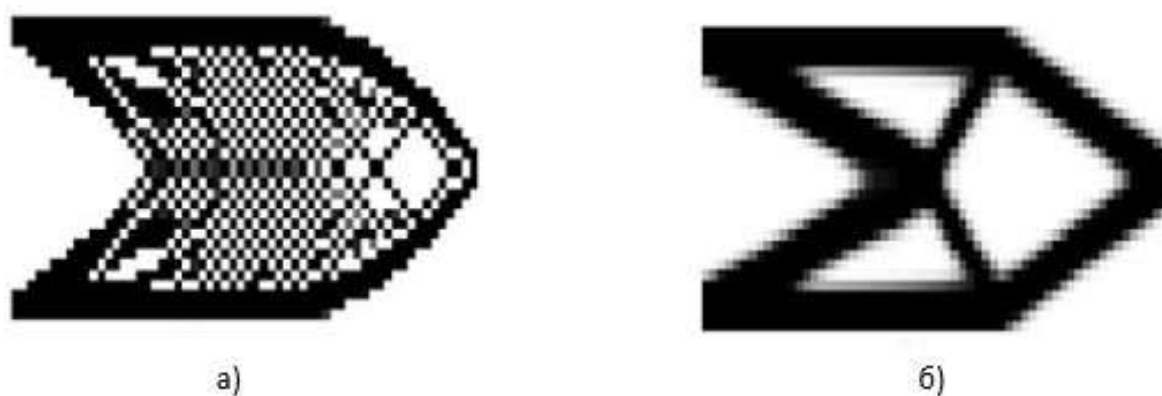
Рисунок 2.4 – Различия между топологическими конструкциями консольной балки: а) с эффектом «шахматной доски» без фильтрации; б) та же конструкция после применения фильтрующей сетки
