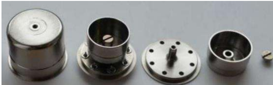
Рисунок 1.13 – ВТГ с низкодобротным объемным резонатором из элинварного металлического сплава: а) – схема устройства ВТГ;
