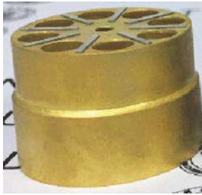
Рисунок 1.24 – ВТГ с низкодобротным объемным резонатором из латуни
