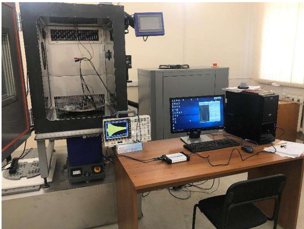
Рисунок 3.9 - Одноосевой имитатор движения Acuitas AG TES-3V TM
