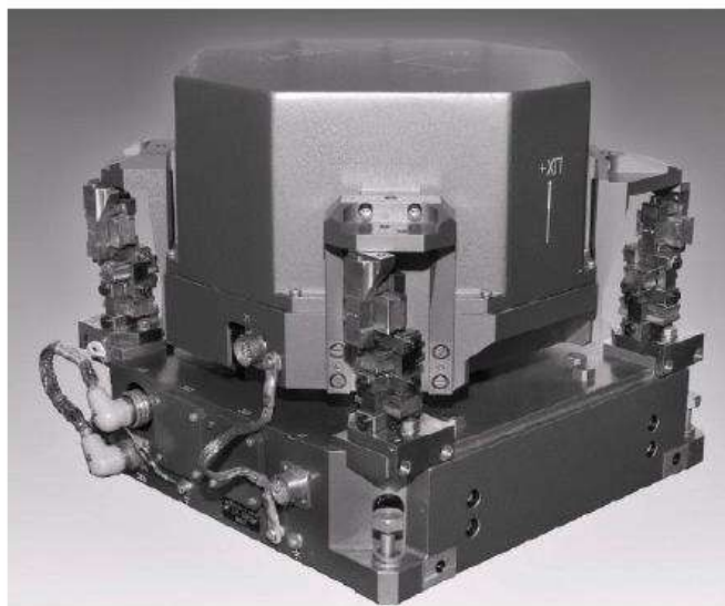
Рисунок 1.9 – Внешний вид опытного образца ИИСО БПЛА на лазерном гироскопе
