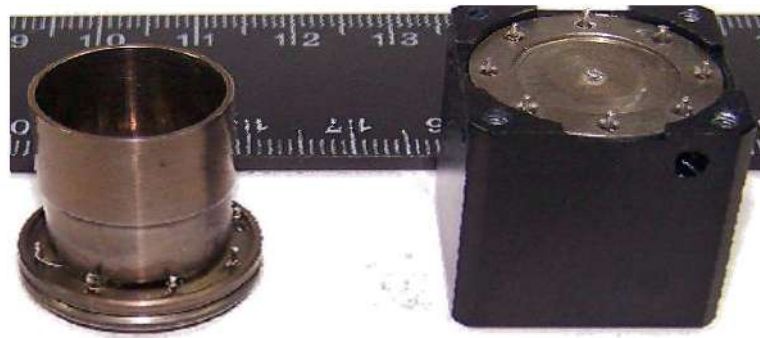
Рисунок 1.21 – 17-мм резонатор КВГ ( Innalabs CVG17 )
