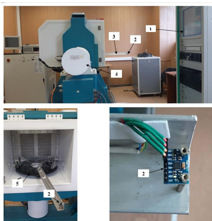
Рис. 4.6 Измерительная часть экспериментальной установки исследования макета СИПВ в лаборатории МАИ: (1) ПК1; (2) МИИБ GY521 (MPU 6050); (3) балка; (4) двигатель внешней оси вращения стенда; (5) установочный стол внутренней оси вращения стенда
